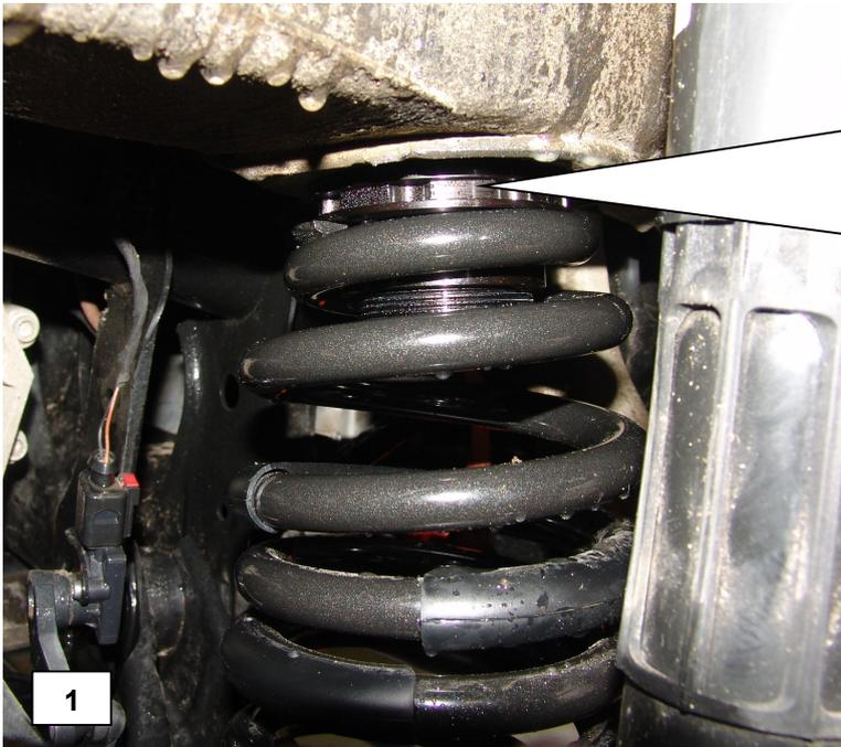
Die Höhenverstellung wird oben montiert u. ersetzt die serienmäßige Federunterlage. Eingestellt ist das minimale Maß! Der max. Verstellbereich beträgt 15mm (siehe Bild 3 und 4).
