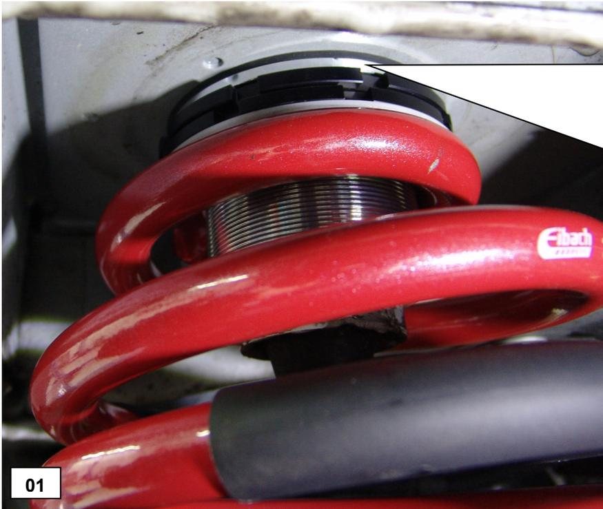
Die Höhenverstellung wird oben montiert u. ersetzt die Serien-Federunterlage. Eingestellt ist das minimale Maß! Der max. Verstellbereich beträgt 15mm (siehe Bild 3).
