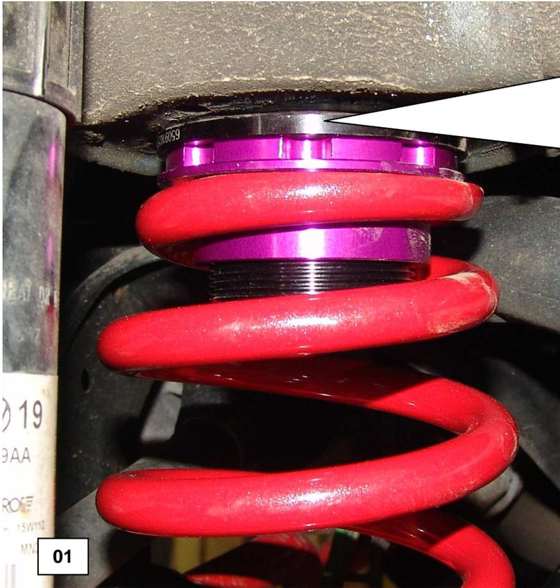
Die Höhenverstellung wird oben montiert u. ersetzt die serienmäßige Federunterlage. Eingestellt ist das minimale Maß! Der max. Verstellbereich beträgt **20mm** (siehe Bild 3).
